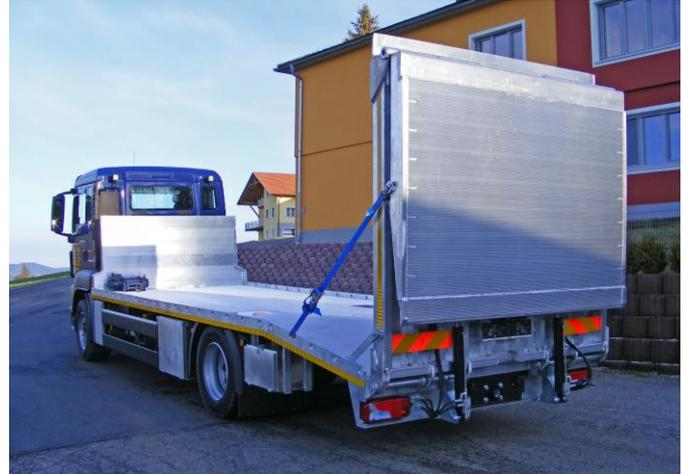
LAGT-R – der ideale Gerätetransport-Aufbau mit längsseitiger Randerhöhung, Abschrägung der Ladefläche am Heck und Auffahrampen – auf LKW 18,0 Tonnen
