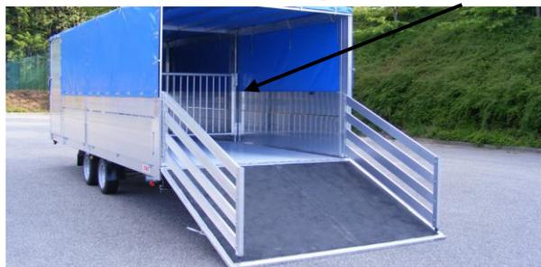
Heckwand mit Gasfeder als Hebehilfe
