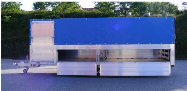
Seitenklappe links vorne mit Anti-Rutsch Auflage
